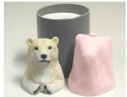
**Fig. 11:** Nach 4 Stunden kann die Silikon Form entfernt werden.
