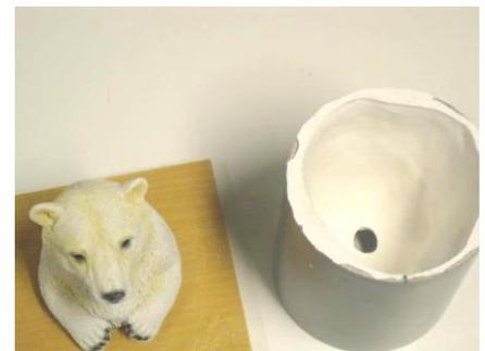
**Fig. 9:** Der Gips und das Plastilin wurden entfernt und das Modell gereinigt.
