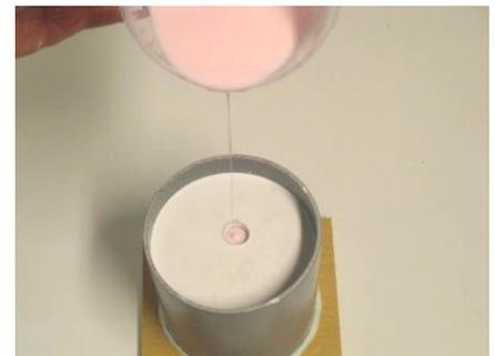
**Fig. 10 :** Das Silikon-Gemisch (mit rotem Farbstoff versetzt) wird in einem dünnen Strahl gegossen.
