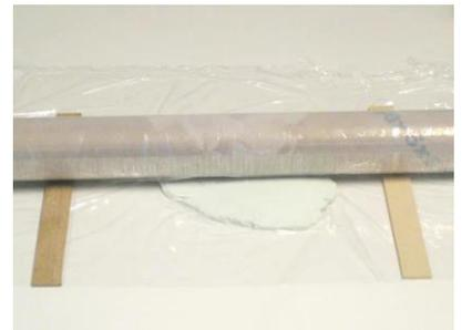
**Fig. 3:** Das Plastilin wird mit einer Walze auf +/- 4mm ausgerollt.
